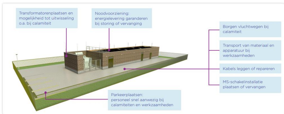
Figuur 7. Impressie van het regelstation van Liander
