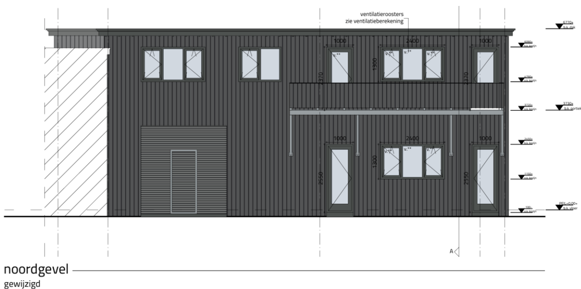
Afbeelding 14 Gevelaanzicht voorzijde en bouwhoogtes nieuwe situatie
