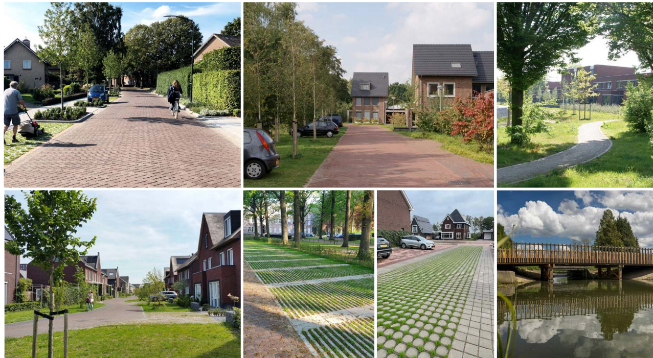
Het groene karakter van het gebied domineert in het straatbeeld, de infrastructuur is te gast dat wordt benadrukt door ingrepen zoals waterdoorlatende verharding, grasbetontegels in de parkeervakken en/of rijbanen in de parkeerkoffer
